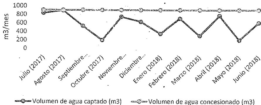
El grafico anterior muestra que la cantidad de agua captada mensualmente del pozo profundo construido en la Granja Avicola San Remo, durante el periodo comprendido entre el segundo semestre del año 2017 y primer semestre del año 2018, se encuentra por debajo del volumen concesionado mediante Resolución No. 0505 del 24 de julio de 2018, el cual corresponde a 907,2 m<sup>3</sup>/mes.
